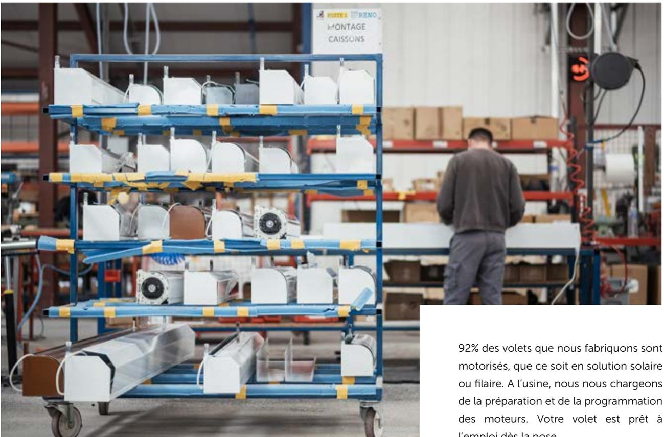
92% des volets que nous fabriquons sont motorisés, que ce soit en solution solaire ou filaire. A l'usine, nous nous chargeons de la préparation et de la programmation des moteurs. Votre volet est prêt à l'emploi dès la pose.
