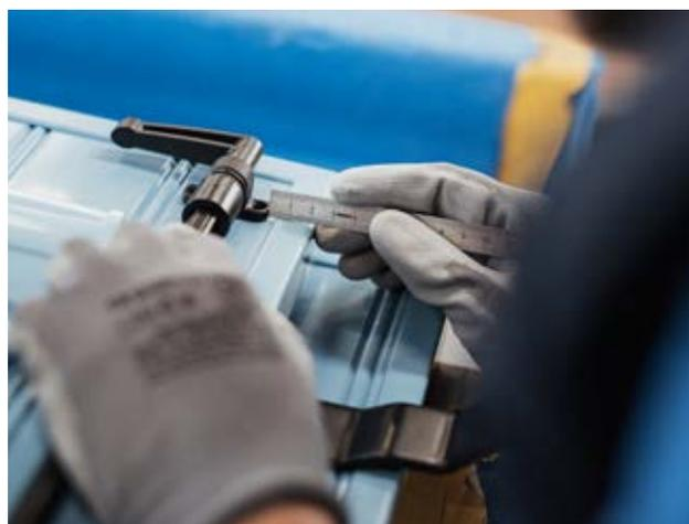
Les volets ne supportent pas l'à peu près ! Comme tous les produits de menuiserie et encore plus lorsqu'il s'agit de sur-mesure, nos collaborateurs doivent vérifier les angles et les cotes à chaque nouvelle étape de la fabrication.
