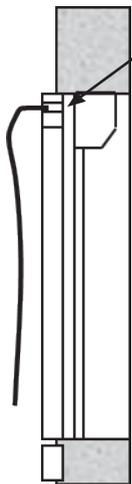
Afin d'assurer une meilleure étanchéité et une finition plus esthétique, finir la pose par un joint de silicone autour des coulisses et du caisson.
